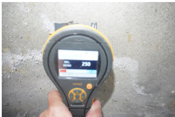
Forhøyet fuktverdier i betongvegger
